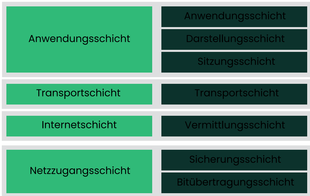
ABBILDUNG 23.1: VEREINFACHTES SCHICHTMODELL FÜR TCP/IP
