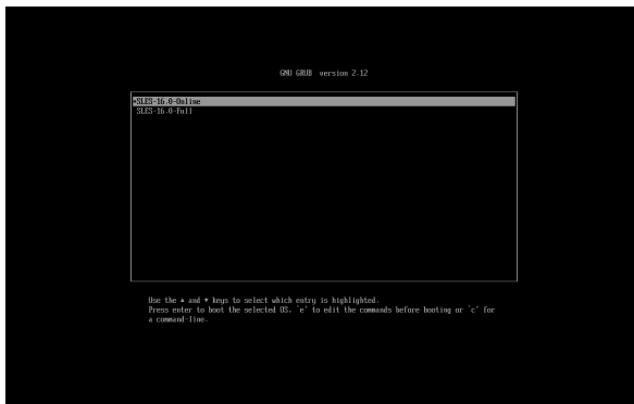
FIGURA 1: SELECCIÓN DEL DESTINO DE INSTALACIÓN EN EL MENÚ DE ARRANQUE PXE
