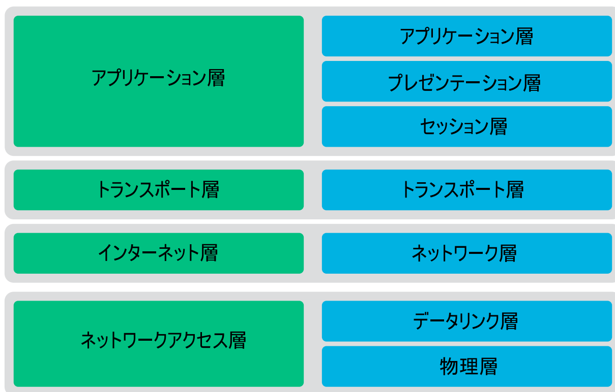
図 16.1: TCP/IPの簡易階層モデル
