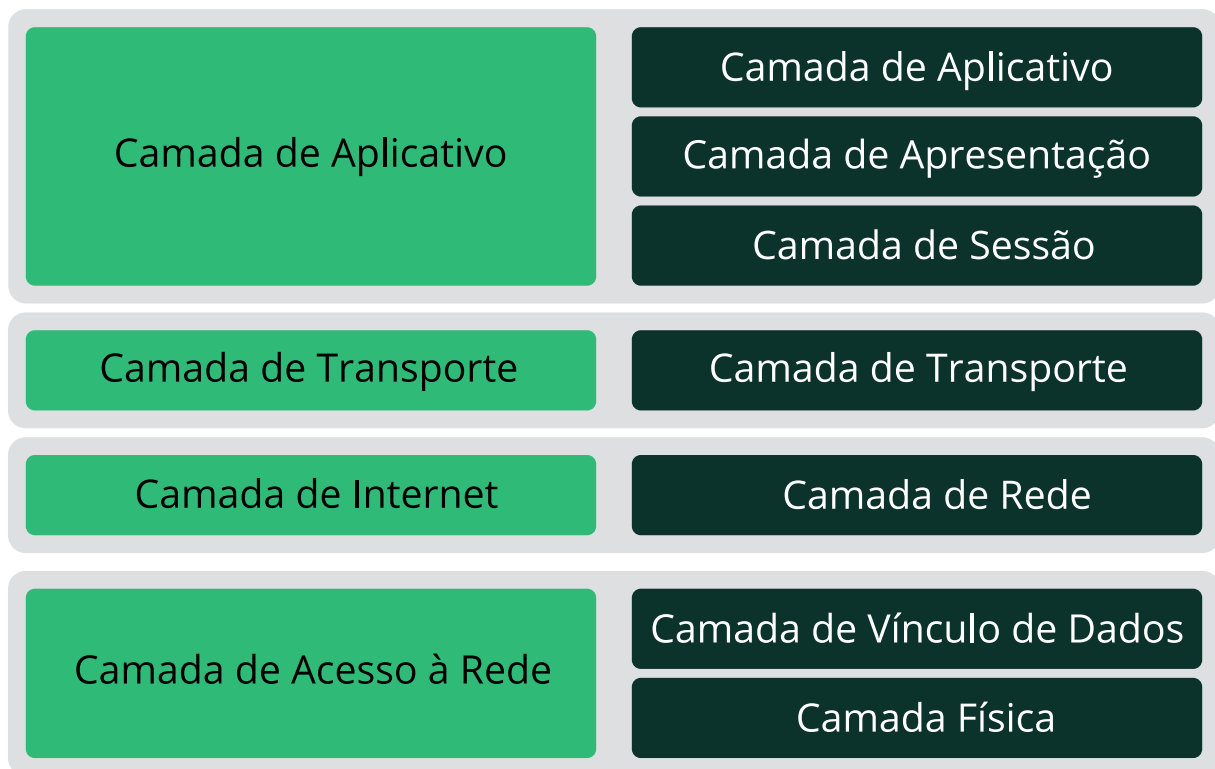
FIGURA 23.1: MODELO SIMPLIFICADO DE CAMADAS PARA TCP/IP
