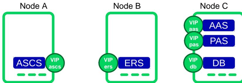
FIGURE 5: DISTRIBUTED INSTALLATION OF THE SAP SYSTEM
