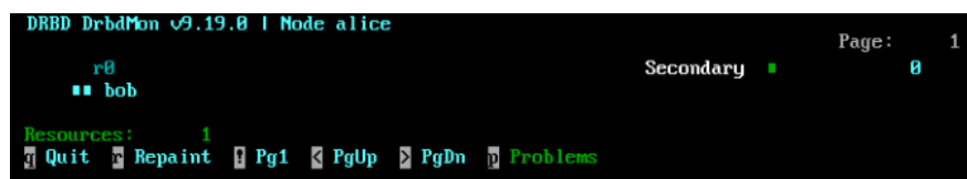
图 22.4：drbdmon 显示了一个正常的连接
