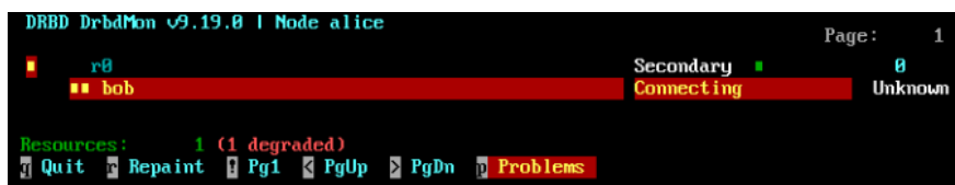
图 22.5：drbdmon 显示了一个错误的连接
