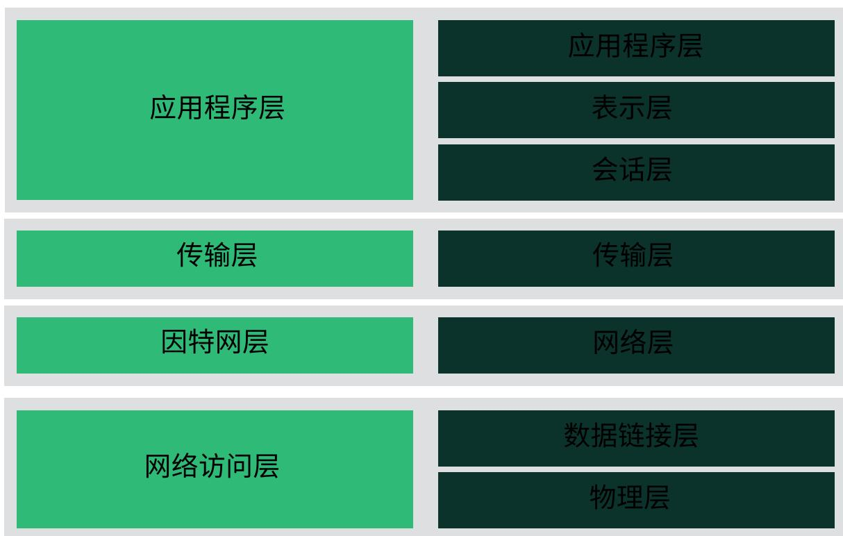
图 23.1：TCP/IP 的简化层模型
