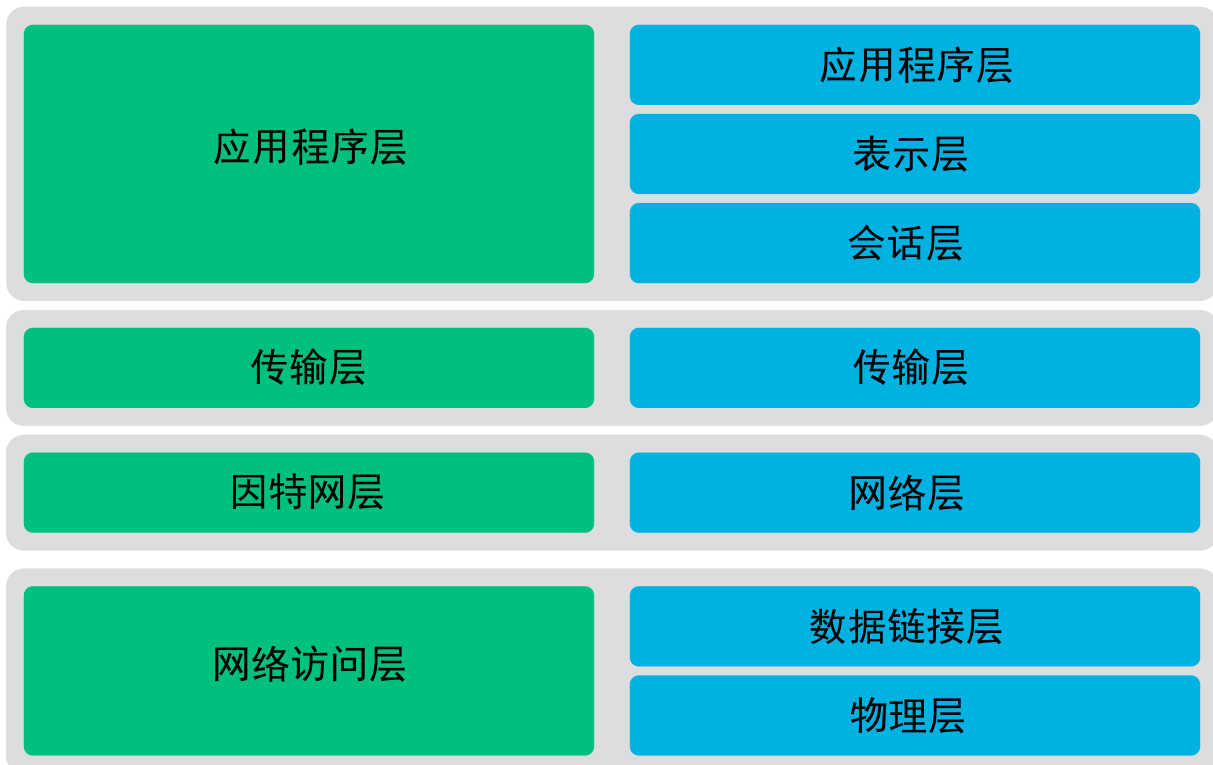
图 19.1：TCP/IP 的简化层模型
