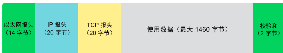
图 19.2：TCP/IP 以太网数据包
