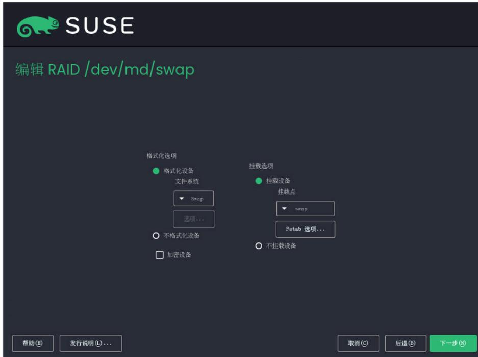
10. (可选) 对于 UEFI 计算机，使用类似的步骤来创建 `/boot/efi` 挂载分区。请记住，`/boot/efi` 仅支持 RAID 1，需要使用 FAT32 文件系统来格式化该分区。
