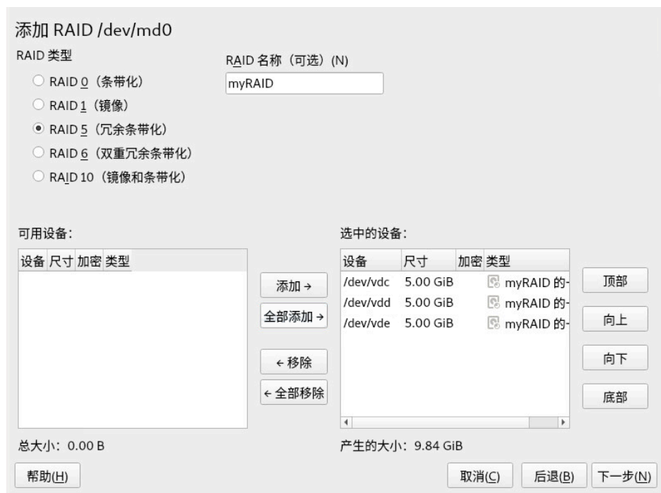
图 7.1：RAID 5 配置示例
