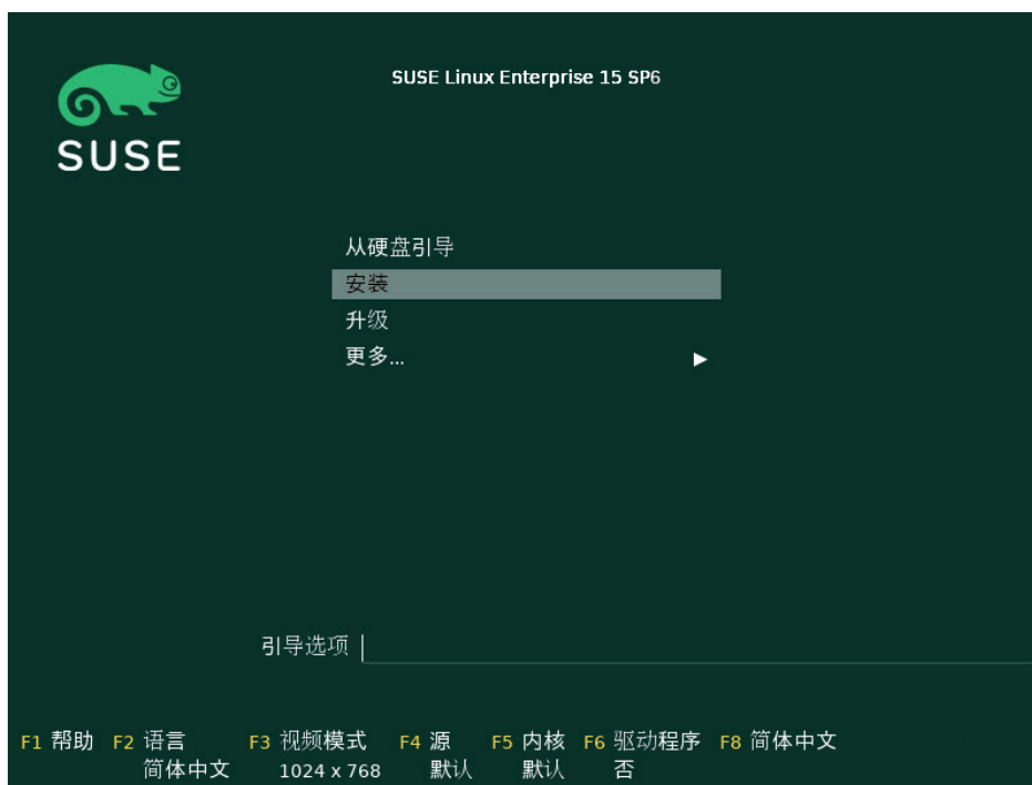
图 8.1：配有传统 BIOS 的计算机上的引导屏幕
