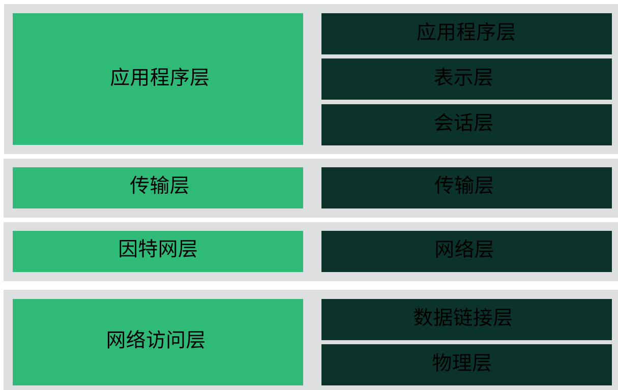
图 23.1：TCP/IP 的简化层模型
