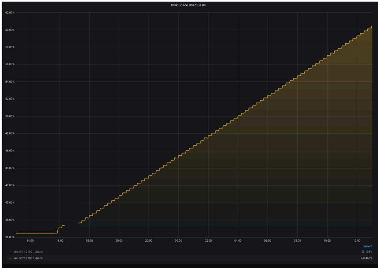
FIGURE 16: DISK FREE CAPACITY IS DROPPING
