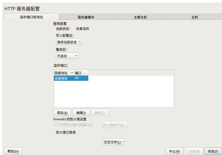
图 36.3：HTTP 服务器配置：侦听端口和地址
