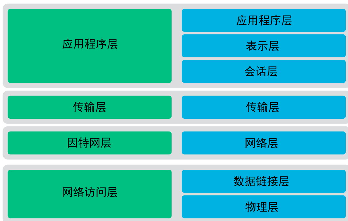
图 17.1：TCP/IP 的简化层次模型
