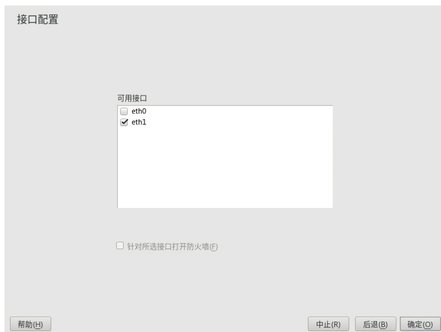
图 31.11：DHCP 服务器：网络接口和防火墙
